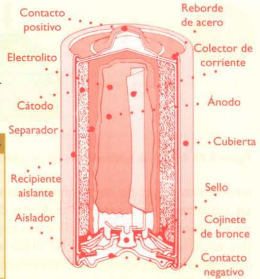
Figura 6.31. Estructura interna de una pila seca
